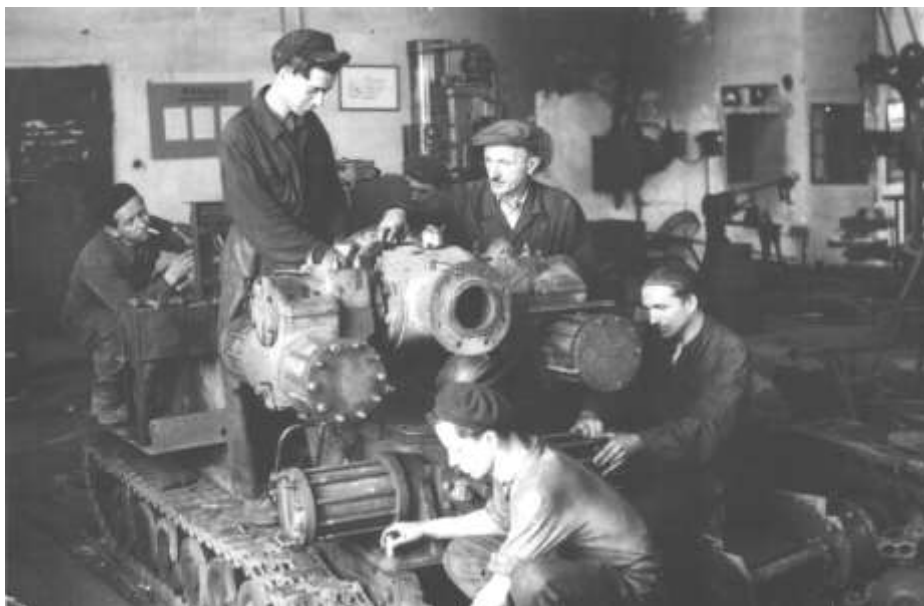
F-4 típusú elővájógép javítása Csori Lajos vezetésével. Látható még Fazekas István , Varga János , Gávallér Gábor , és ifj. Szelke ede .
